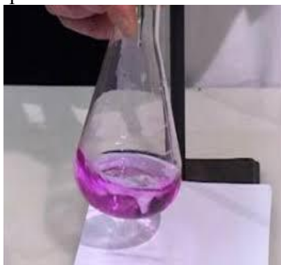
Рис.3.3. Зміна забарвлення розчину при титруванні ЕДТА
